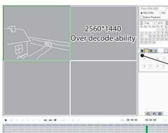
Si une caméra Wi-Fi est connectée avec une ou plusieurs caméra(s) filaire(s), l'affichage unique doit être utilisé pour visualiser les caméras Wi-Fi. Les caméras Wi-Fi disposent d'une très haute résolution et ne peuvent pas être visualisées en même temps que les caméras filaires (résolution standard.). Elles doivent être visualisées en vue unique, séparément.
